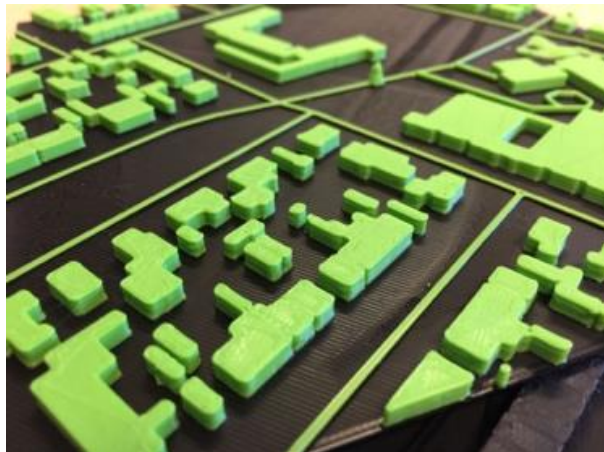
3D-geprinte kaart met een printer met twee kleuren (2 extruders).
