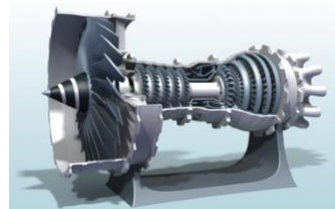
3D-doorsnede van een vliegtuigmotor. De onderdelen bewegen ook echt en zijn uit het omhulsel te halen om beter de details te herkennen. Bron: Chris Shakal. Het model is gratis te downloaden van grabcad.com.
